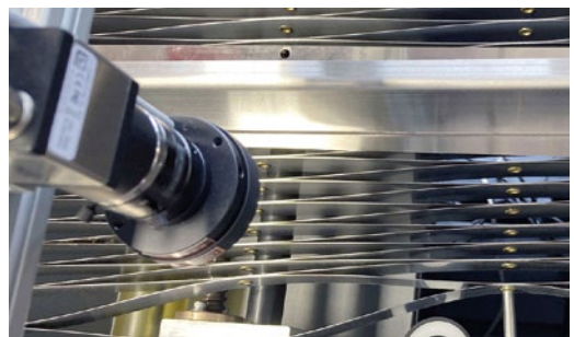
kvInspect integriert in eine Falzanlage von GUK (I). Als Mehrkameranystem lassen sich Produkte auch beidseitig prüfen.
