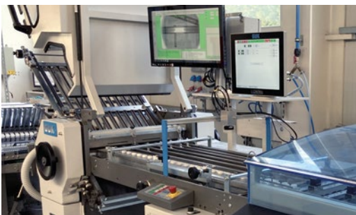
kvInspect integriert in eine Falzanlage von GUK (I). Als Mehrkameranystem lassen sich Produkte auch beidseitig prüfen.
