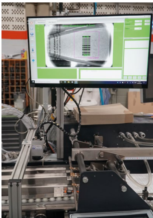
Die kvInspect-Kamera von Kaiser Vision sitzt direkt am Bogeneinlauf. Auf dem Bildschirm zu sehen sind die Details der Pharmacode-Lesung eines Beipackzettels.
