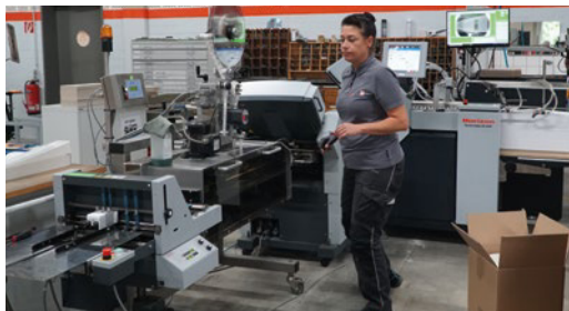
Maschinenbedienerin Rebecca Krämer an einer der beiden Horizon AF-408F. Der Prüfmonitor des Inspektionssystems hängt in Sichthöhe über der Anlage.
